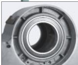
**Износостойкий, точный рабочий шпиндель на шарикоподшипниках**
