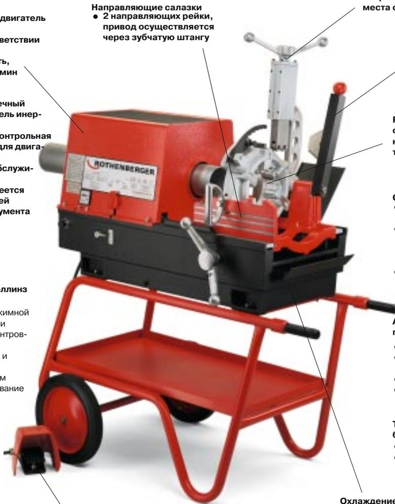
Рисунок: Станок на транспортировочной тележке
