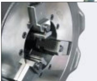
**Зажимной патрон ударного действия со сменными плавающими широкими губками для надежной фиксации**
